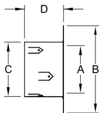
Raccorde un conduit EXCELPrime 6" à l'ouverture d'une cheminée de maçonnerie de 7" ou 8".
