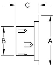
Ferme l'ouverture d'une cheminée de maçonnerie existante précédemment utilisée pour évacuer un autre appareil. L'obturbateur de cheminée de maçonnerie peut fermer une ouverture ronde d'un diamètre allant jusqu'à 8" et il est doublé d'isolant pour bloquer les courants d'air froid.
