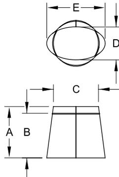
Raccorde EXCELPrime aux poêles avec une sortie de conduit ovale. Offert en 8" seulement.
