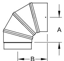
L'angle de ce coude est réglable entre un angle 90° et un conduit droit. Brevet déposé.
