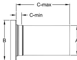
Peut être utilisé pour remplacer le prolongement de conduit EXCEL (EX) dans les installations EXCELPrime. Cette version de 12" de long s'insère dans une longueur normale et élimine ainsi le besoin d'une longueur ajustable.
