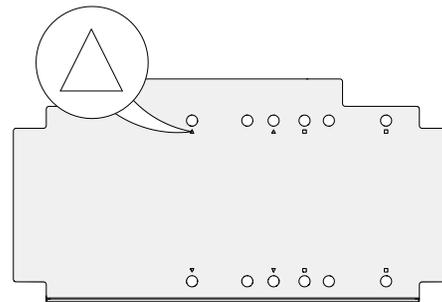
2. S'il est nécessaire de changer la position de la plaque de montage universelle, vérifiez d'abord si elle s'insère dans l'ouverture du foyer avec la plaque de montage fixée. Certains foyers exigent que la plaque de montage soit retirée pour que le ventilateur passe à travers l'ouverture du foyer.
