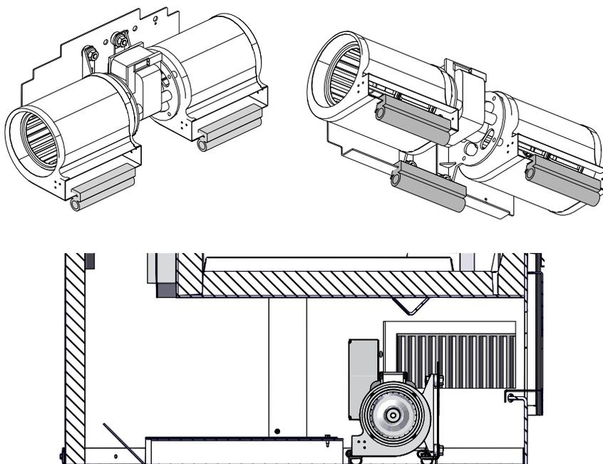
4. Remplacez l'écran radiant de plancher (sauf Delta). **Pour les Focus SBR, Opel (toutes versions), Focus 320, Onyx2** l'écran radiant est composé de deux parties. Une fois le ventilateur interne installé, l'écran doit être modifié. Retirez la vis et faites chevaucher la partie avant avec la partie arrière. Si jamais vous retirez le ventilateur, assurez-vous de remettre les deux parties de l'écran radiant dans leur position originale.
