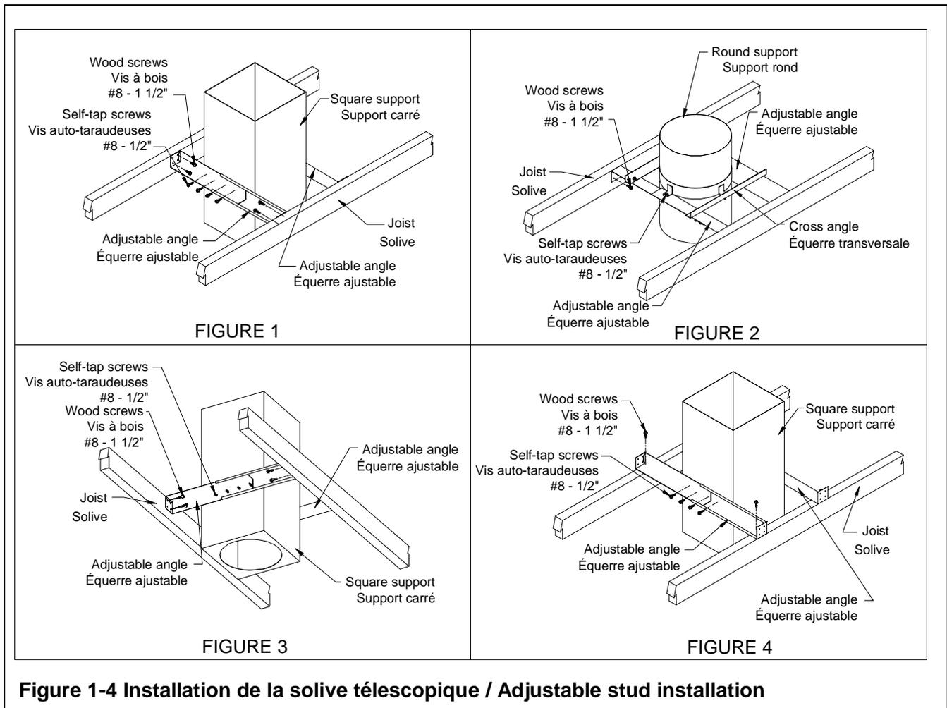
**Figure 1-4 Installation de la solive télescopique / Adjustable stud installation**
