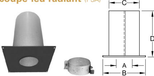
Calibré pour supporter jusqu'à 30" (3") ou 25" (4") de conduits de ventilation qui passent à travers un plancher ou un plafond. S'agrandit de 12" à 23" pour garder l'isolation et les débris loin du conduit.
