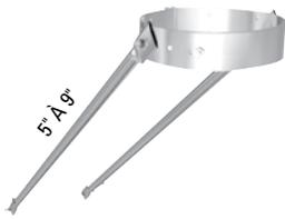
**Les tiges en acier inoxydable pour bride de toit ajustable (ESRB) sont maintenant disponibles.** La bride de toit est utilisée pour fournir le support latéral à une cheminée qui se prolonge de plus de 5' au-dessus du toit. La bride de toit utilise un collier universel pour s'adapter aux cheminées de 6", 7" et 8" de diamètre. Les perches de la bride sont télescopiques de 5 pi à 9 pi de longueur.
