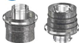
Permet aux appareils approuvés d'utiliser un conduit flexible coaxial en aluminium plutôt qu'un conduit rigide EXCELDirect. Le ØCFA comprend un adaptateur de raccordement à l'appareil, un adaptateur de raccordement à la terminaison et un collier de serrage. Le conduit flexible coaxial n'est pas inclus.
