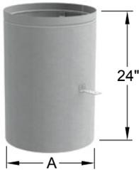
Le coupe-feu de toit est nécessaire pour les installations de foyers Renaissance. Conçu pour protéger les toits combustibles qui sont traversés par la cheminée, il est doté de supports permettant d'ajuster la hauteur du coupe-feu en fonction de la pente de toit. Les coupe-feux radiants ne réduisent PAS le dégagement de la cheminée. Un dégagement de 2" de la cheminée doit être maintenu en tout temps aux solives lorsque la cheminée traverse les coupe-feux radiants.
