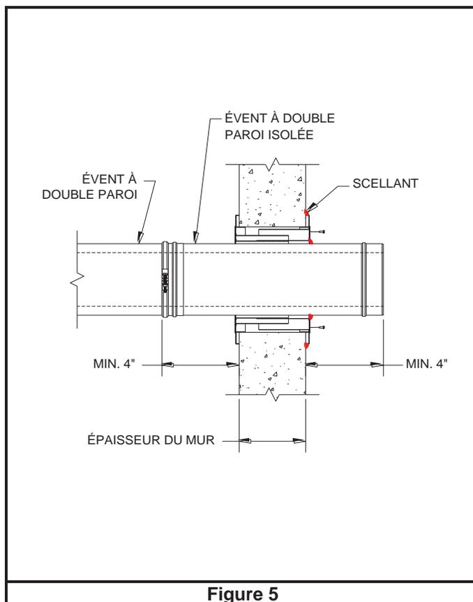
4. Installez l'évent en commençant par l'extrémité raccordée à l'appareil. Assurez-vous de poser une bride horizontale tous les 6' (8' si les joints des parois extérieures sont vissés ensemble) ou après chaque changement de direction de l'évent.
