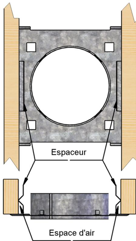
**Figure 2** Encadrement de l'adaptateur de grille
