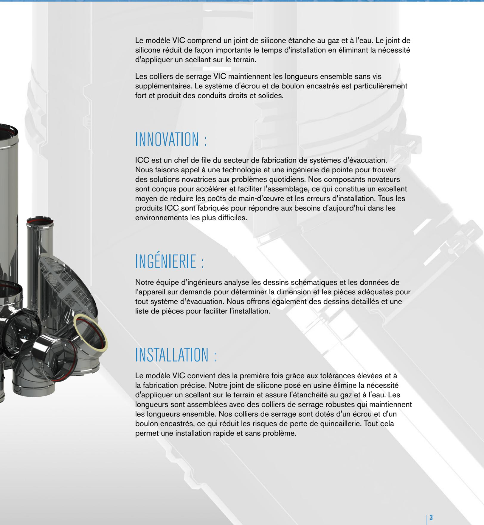
Le modèle VIC comprend un joint de silicone étanche au gaz et à l'eau. Le joint de silicone réduit de façon importante le temps d'installation en éliminant la nécessité d'appliquer un scellant sur le terrain.
