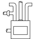
Façade neutre avec chauffage central et sortie d'air chaud complémentaire
