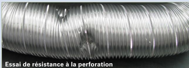
Essai de résistance à la perforation
