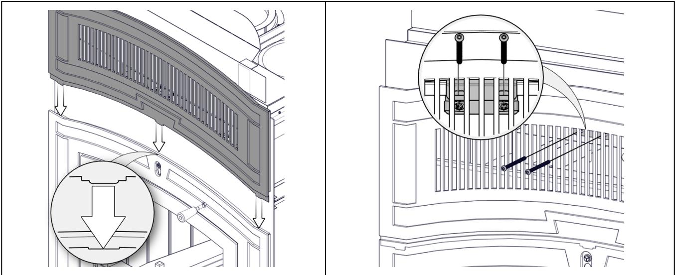
5. En utilisant la clé polygonale  $\frac{7}{16}$ ", vissez l'écrou sur la nouvelle grande clé de voute presque au complet. Insérez l'écrou de la clé de voute à travers le trou de la façade décorative et tirez la clé de voute vers le bas. Finissez de visser l'écrou avec la clé polygonale.
