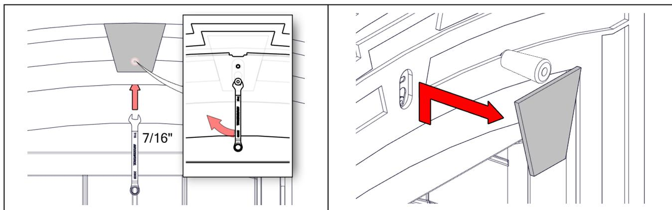
2. Maintenant, il faut installer le support de vis au haut de l'ouverture de la persienne supérieure. Le support de vis doit être centré sur la largeur. Il suffit de pousser vers le haut sur le caisson intérieur pour insérer le support de vis entre le pli de l'ouverture de la persienne supérieur et le caisson. Une fois en place, tirez le support de vis au maximum vers l'avant. Installez une attache filetée en "U" sur chacun des trous du support de vis.
