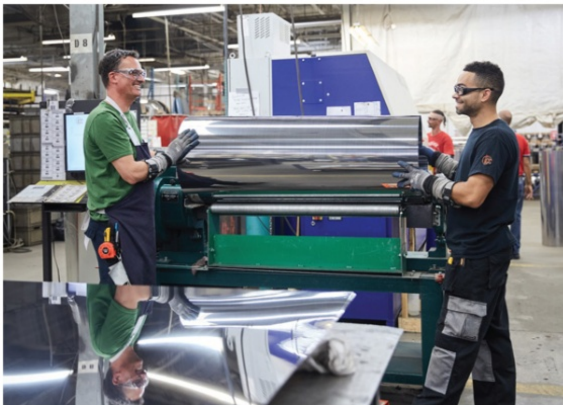
Deux employés d'ICC occupés à rouler une cheminée de grand diamètre en acier inoxydable.
