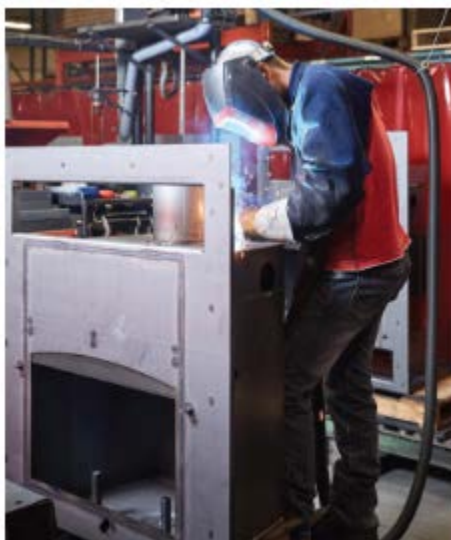
Soudeur à l'œuvre sur les touches finales d'une boîte à feu du foyer Opel, de la gamme RSF.
