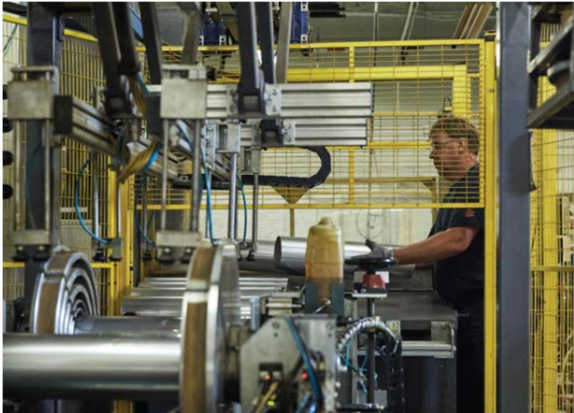
Une des deux machines de soudage laser automatisé d'ICC servant à la fabrication des conduits et des parois pour ses produits de cheminées résidentielles.
