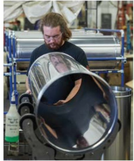
Fabrication d'évents à condensation VIC de la gamme de produits industriels d'ICC.
