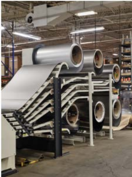
Alimentateur multi-bobines à changement rapide pour la nouvelle ligne de coupe haute précision d'ICC
